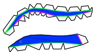
↑インテイクバーを組み立てたあと、ボンネットに裏から組み込む。
